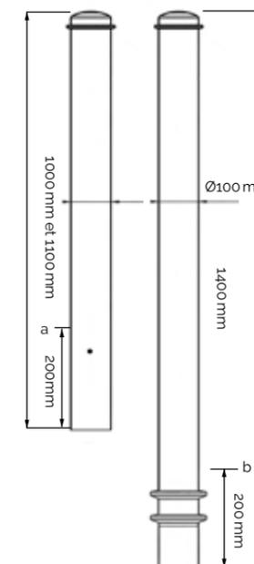
a : niveau minimum de scellement pour version 1000 mm et 1100 mm avec trou pour passage de fer à béton Ø10 mm longueur 140 mm
