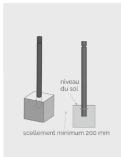
En cas de pose par carottage, il est recommandé un diamètre minimum de carottage de 1,5 fois le diamètre du potelet.
