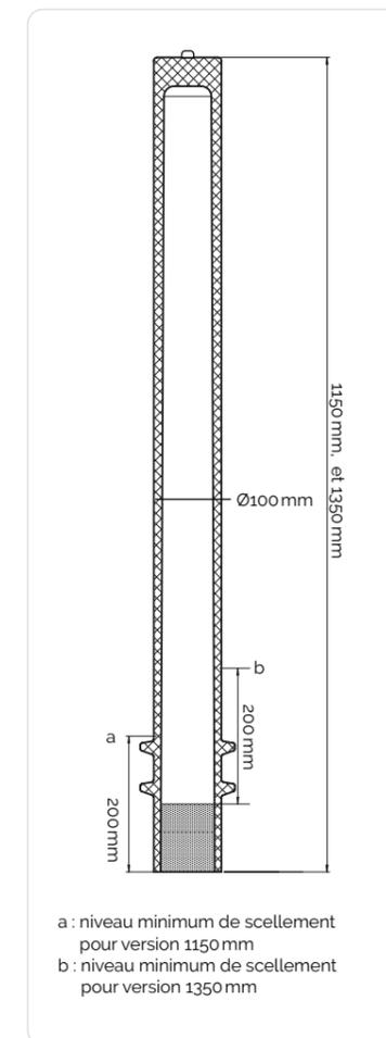
a : niveau minimum de scellement pour version 1150 mm
